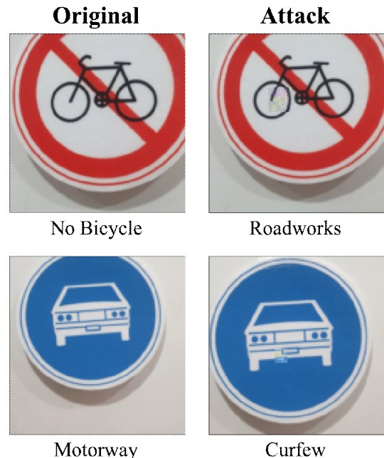
[그림 3] 제안하는 기법의 적대적 패치를 통한 교통표지판 모형 분류 모델 공격 예시
